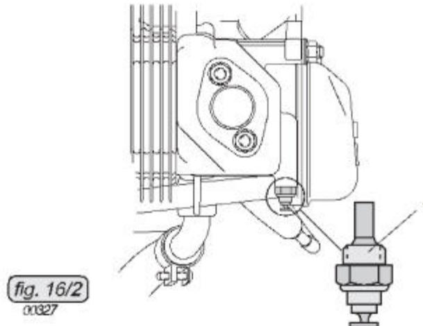
La medida de la temperatura de salida del liquido refrigerante es llevada a cabo un sensor independiente que debe de ser instalado en la linea entre el deposito de expansion (1) y la entrada al radiador
