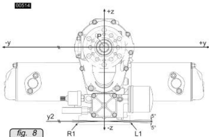
Desviación tolerada del eje Y  $\pm 5^\circ$  (ver Fig.8)
