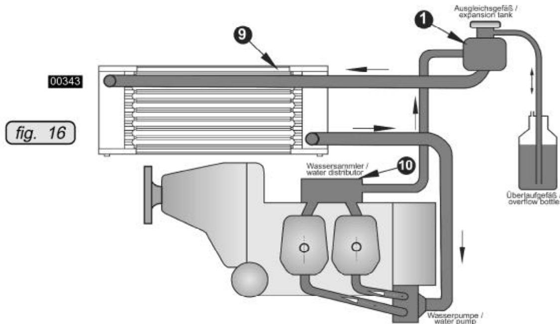
En una instalación como la que se muestra con el radiador ⑨ en una posición más alta que el tanque de expansión estándar suministrado, tiene que ser conectado un acumulador de agua ⑩ en lugar del tanque de expansión. Adicionalmente, tiene que ser instalado un tanque apropiado de expansión en el punto más alto del circuito de refrigeración.
