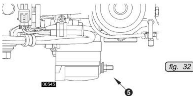
Líneas de alimentación para el arranque eléctrico, al lado derecho del alojamiento de la magneto.
