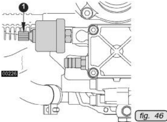
☞ Posición de conexión sobre el captador de presión de aceite ①
