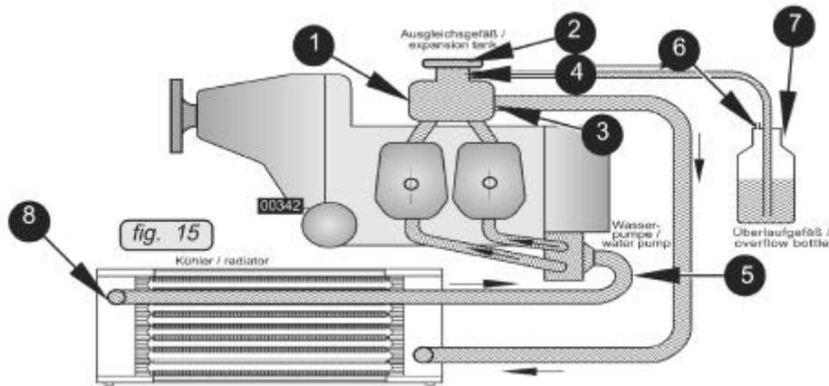
◆ **NOTA:** En la versión estándar del motor, el tanque de expansión **1** se conecta sobre la parte superior del motor (ver Figura 15).
