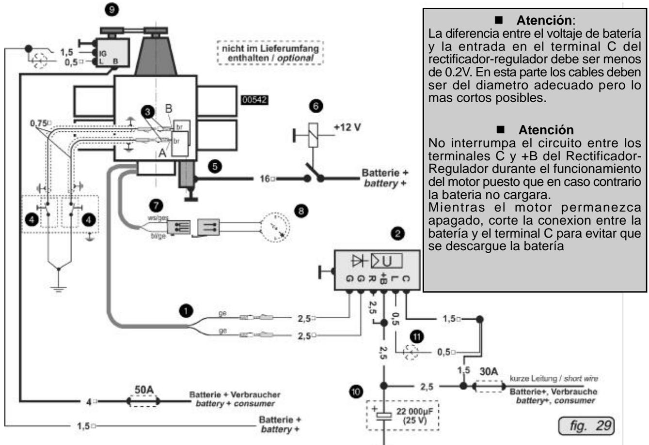
**17.1) Datos Técnico y conexión de los componentes eléctricos**
