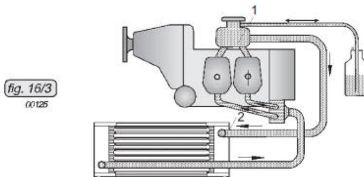
El sensor puede ser instalado en una "TEE" en la tubería o en el vaso de expansion. El sensor no es distribuido por BRP-Rotax).
